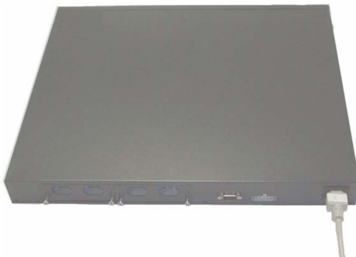
Rysunek 1-2. Podłączanie kabla zasilania
